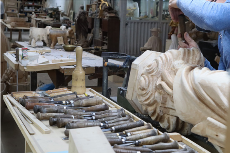
Fig. 1. Banco do escultor imaginário com o maço, os devidos ferros e o torno Fonte: Fotografia de Cecília Cardoso, 2021. Oficina Casa Arte Sacra Fânzeres
